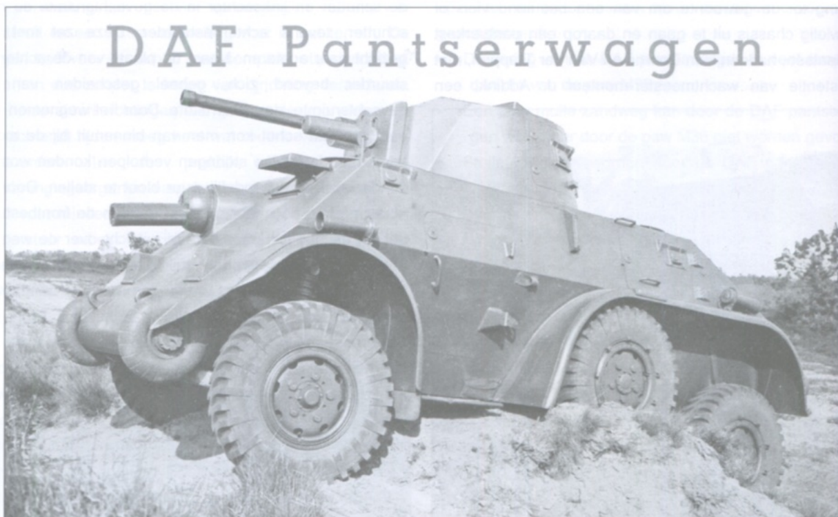
DAF proefpantserwagen, hier met een door DAF zelf vervaardigde dummy toren.
