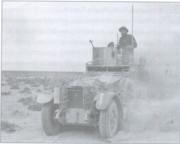
Een Rolls Royce Type 1940 van de 11th Hussars in de woestijn in Noord-Afrika. De vorm van de nieuwe toren is duidelijk te zien. De bewapening bestaat uit een .5 inch Boys antitank geweer, een bren mitrailleur en een rookbuswerper.
